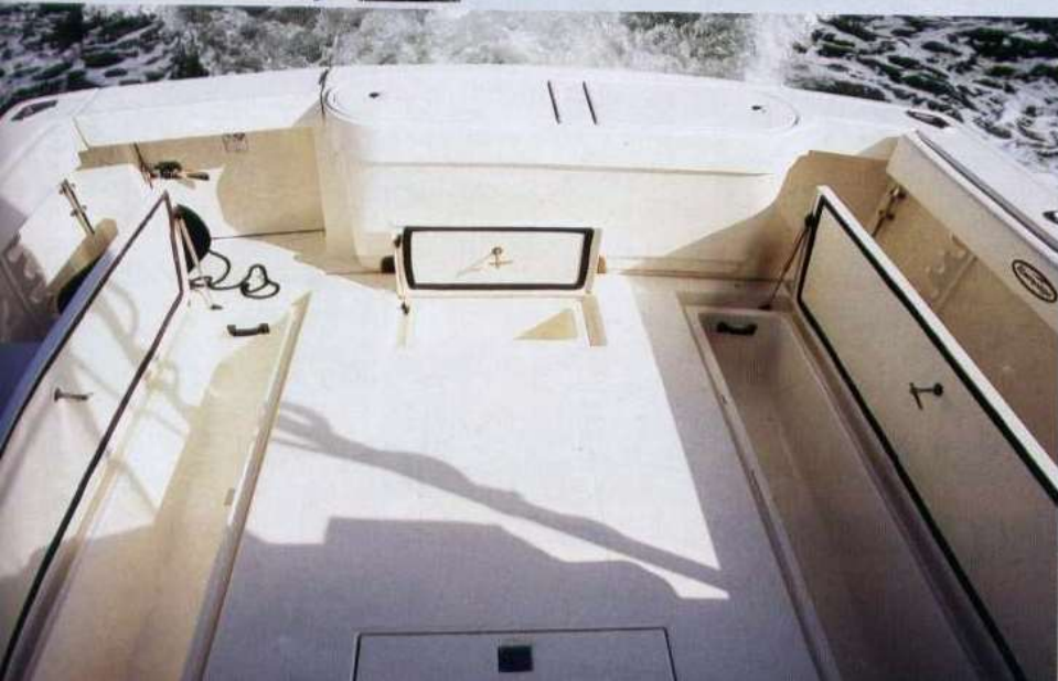
A sinistra, i passavanti non sono ostacolati dai divergenti. Sopra, la timoneria sul tuna tower. Sotto, il pozzetto è provvisto di tre vasche per il pescato sotto al pagliolato e di una vasca per il vivo, con doppia apertura, nel coronamento.
